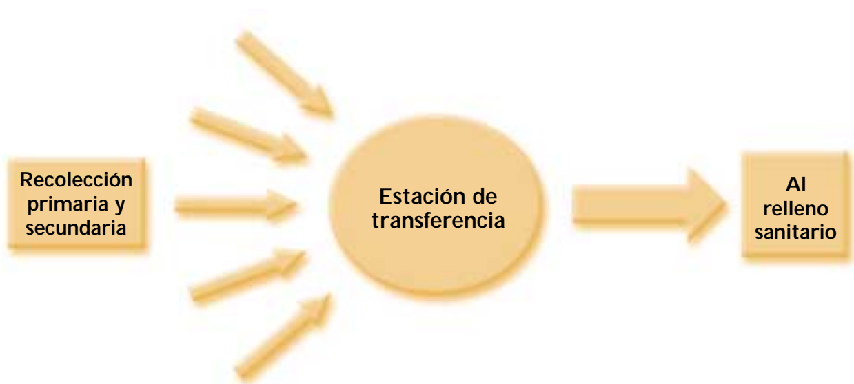
Figura 5.3: Esquema de operación de una estación de transferencia
