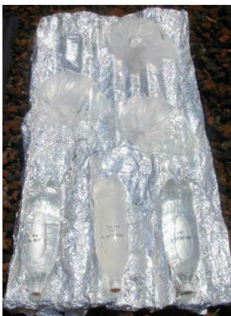
Figura 14. Desinfección solar de agua en bolsas y botellas de polietileno
