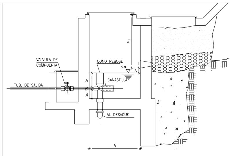
**Figura 1.4 Altura total de la cámara húmeda**
