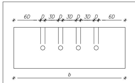
**Figura 1.3 Distribución de los orificios de pantalla frontal**
