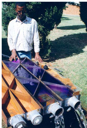
Instalación típica de un equipo de radicación UV con lámpara fuera del agua
