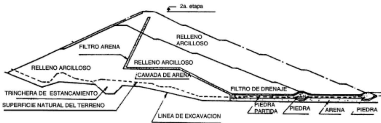
Figura 5 - Sección típica de presa de tierra
