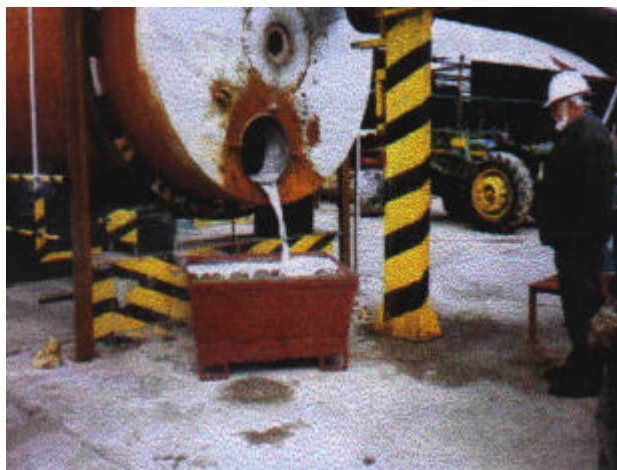
Foto 3. Procedimiento para la colada metálica (Lingotera)
