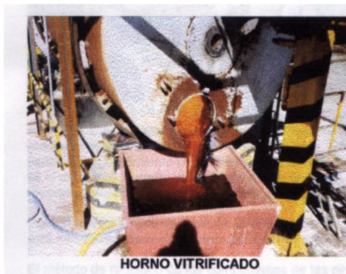
Foto 2. Salida del horno del material vitrificado
